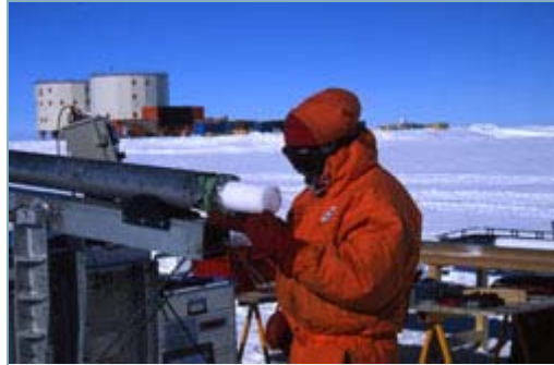
Extraction de carotte de neige sur le site de la base Franco-Italienne de Dôme Concordia, Antarctique.
